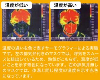
温度の違いを色で表すサーモグラフィーによる実験です。左の排気弁付きのマスクでは、呼吸をスムーズに排出しているため、熱気がこもらず、温度が低いことを示す青色になっています。右の排気弁無しマスクでは、体温と同じ程度の温度を示す赤色になっています。
