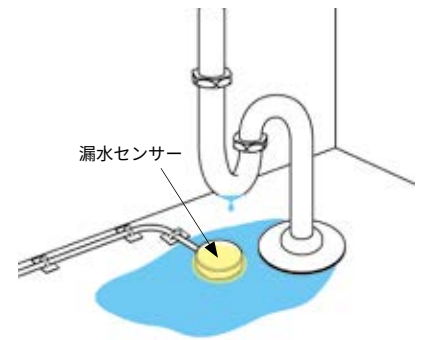
水道周りにポイント漏水センサーを取り付け
