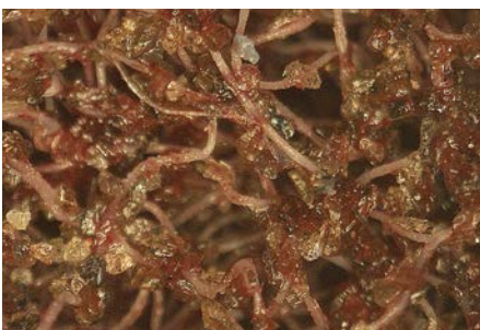
研磨材表面の顕微鏡写真 (50倍)
