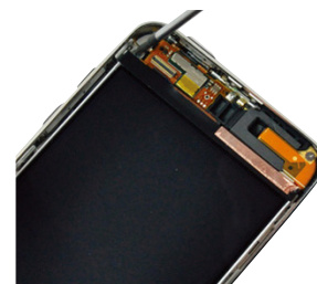
● LCDモジュールFPCのシールドイング
