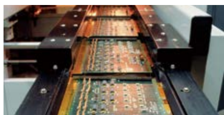
プリント基板のはんだ付け工程でのマスキング
