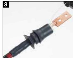
端子取付け後、端末外被を装着。 ※ ケーブルシース部および端子充電部の防水処理にテープ巻きが不要です。
