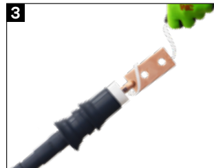
3 端子取付け後、端末外被を装着。 ※ケーブルシース部および端子充電部の防水処理にテープ巻きが不要です。
