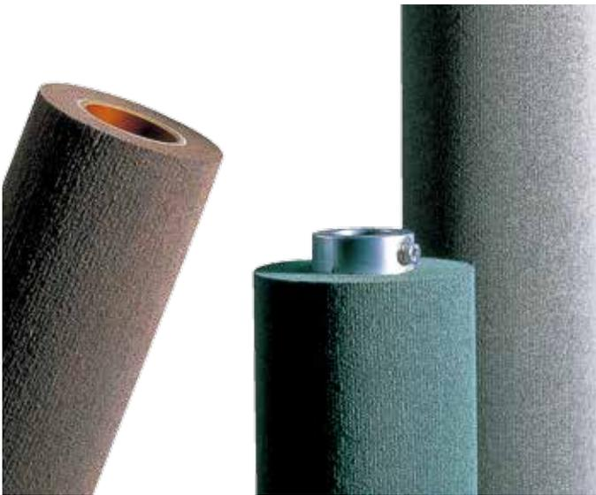
フラップタイプ構造のスコッチ・ブライト™ 不織布表面処理材原反に、樹脂含浸処理を施した製品です。優れた研磨能力と安定した仕上がりバランス良く得られます。プリント基板のあらゆる研磨用途に対応しますが、特に印刷用ドライフィルムラミネート前の整面研磨用途に関しては、多くのお客様より常に高い評価をいただいております。砥粒にはシリコンカーバイドを使用。グレード(粗さ)、硬度には多くの種類があり、お客様のご要望に沿った製品を選定できます。
