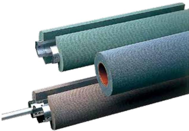
フラップタイプ構造のスコッチ・ブライツ™ 不織布表面処理材相反に、ウレタン発泡樹脂を含浸させた製品です。発泡樹脂含浸により、当社従来品のフラップタイプ不織布研磨材よりも長寿命を実現し、かつソフトな仕上がりが得られるため、特にソルダーレジスト前研磨用途に優れた効果を発揮します。
