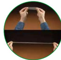
O alongamento aumenta com a força aplicada e a fita não rompe até 720% de esticamento. Isso significa maior confiança e estabilidade da carga para a movimentação dentro e fora da empresa.
