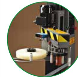
O equipamento pré-estira a fita, mantendo a mesma tensão aplicada do topo à base do pallet.
