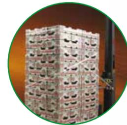
Estira e aplica a fita do topo à base do pallet automaticamente: envolve também sobre a borda superior e em torno da base do pallet para impedir deslocamentos laterais.
