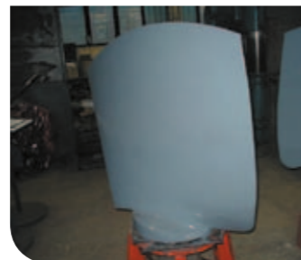
Восстановление лопатки турбины с помощью 3M™ Scotchkote™ Epoxy Metal Repair XG 509 с последующим покрытием эпоксидным керамонаполненным материалом 3M™ Scotchkote™ Epoxy Ceramic Surfacer CR 511 для получения гладкого финишного покрытия с низким трением.
