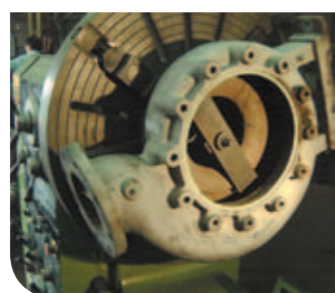
Кожух насоса, восстановленный с помощью керамонаполненного эпоксидного материала 3M™ Scotchkote™ Epoxy Ceramic Rebuild EG 513. Второй слой покрытия 3M™ Scotchkote™ Epoxy Ceramic Surfacer FG 512 нанесен для получения гладкого финишного покрытия с низким трением.
