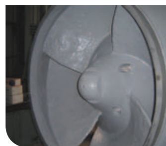
Восстановление крыльчатки насоса с помощью эпоксидного керамонаполненного материала 3M™ Scotchkote™ Epoxy Ceramic Rebuild EG 513 для ликвидации коррозионного повреждения с последующим покрытием 3M™ Scotchkote™ Epoxy Ceramic Surfacer FG 512 для получения гладкого финишного покрытия.
