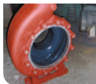
Кожух насоса, восстановленный с помощью керамонаполненного эпоксидного материала 3M™ Scotchkote™ Epoxy Ceramic Rebuild EG 513. Второй слой покрытия 3M™ Scotchkote™ Epoxy Ceramic Surfacer FG 512 нанесен для получения гладкого финишного покрытия с низким трением.
