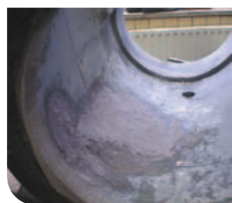
На рисунке показана подготовленная с помощью пескоструйной обработки поврежденная коррозией и эрозией труба («До») в дальнейшем покрытая керамонаполненным эпоксидным материалом 3M™ Scotchkote™ Epoxy Ceramic Surfacer FG 512.
