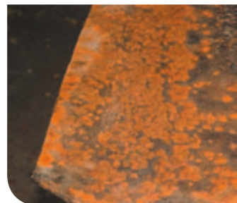
Восстановление лопатки турбины с помощью 3M™ Scotchkote™ Epoxy Metal Repair XG 509 с последующим покрытием эпоксидным керамонаполненным материалом 3M™ Scotchkote™ Epoxy Ceramic Surfacer CR 511 для получения гладкого финишного покрытия с низким трением.
