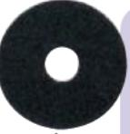
ハイプロパッド               | ●剥離作業／ストリッピングパッドでは取りきれない、古いワックスや厚塗りされたワックスの剥離用<br>●コンクリート面のバリ取り、クリーニング用        | ①通常ボリッシャーのパッド台に装着します。<br>②ハイプロパッドが薄くなってきた場合には、パッド台とハイプロパッドの間に赤または白パッドをはさんで使用してください。黒や緑などのパッドでは、ボリッシャーを傾けるとパッドがずれることがあります。<br>③使用後はパッド台からはずし、強い流水でパッドに付着した汚れやワックスのかすを洗い流して乾燥させてください。                                                          | 175~500回転 |
