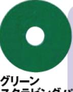
グリーンスクラビングパッド        | ●表面洗浄作業用                                                                       | ①通常ボリッシャー、自動洗浄機のパッド台に装着します。<br>②洗剤を用いてワックスの汚れを洗浄します。<br>③使用後はパッド台からはずし、流水でパッドに付着した汚れやワックスのかすを洗い流してから乾燥させてください。                                                                                                                               | 175~500回転 |
