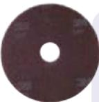
サーフェスピリバレーションパッド(SPP) | ●強力表面洗浄作業                                                                      | ①通常ボリッシャーのパッド台に装着します。(凹凸のある床面の場合、パッド台とSPPの間に赤または白パッドをはさんで使用してください。)<br>②水を用いてワックス表面の洗浄作業を行います。剥離剤や洗剤を使用すると目詰まりしやすくなります。作業後はモップにて1~2回表面を拭きあげます。乾燥後、ワックスの足し塗りを行ってください。<br>③使用後はすぐにパッド台からはずし、強い流水かバケツにためた水でゆいで、付着した汚れやワックスのかすを洗い流してから乾燥させてください。 | 175~500回転 |
