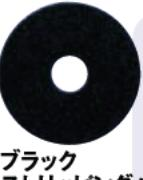
ブラックストリッピングパッド        | ●剥離作業用                                                                         | ①通常ボリッシャーのパッド台に装着します。<br>②剥離剤を用いてワックスを剥離します。<br>③使用後はパッド台からはずし、流水でパッドに付着した汚れやワックスのかすを洗い流してから乾燥させてください。                                                                                                                                       | 175~500回転 |
