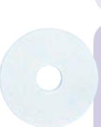
ホワイトスーパー・ポリッシュパッド   | ●ワックスのつや出し作業、焼き付け作業用                                                           | ①通常ボリッシャーのパッド台に装着します。<br>②空バフでワックスのつや出し、焼き付け作業をします。<br>③使用後はパッド台からはずし、強い流水でパッドに付着した汚れやワックスのかすを洗い流してから乾燥させてください。                                                                                                                              | 175~500回転 |
