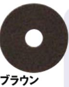
ブラウンストリッパー・パッド      | ●剥離作業用(あまり汚れていない所の剥離)<br>●洗浄作業にも使用できますが、ワックス面に傷をつけ、光沢を落とすことがあります。<br>●No.303併用 | ①通常ボリッシャーのパッド台に装着します。<br>②剥離剤を用いてワックスを剥離します。<br>③使用後はパッド台からはずし、強い流水でパッドに付着した汚れやワックスのかすを洗い流してから乾燥させてください。                                                                                                                                     | 175~500回転 |
