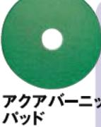
アクアバーニッシュ<br>パッド    | ●超高速バフイング作業用              | ①バフイングの前に床の汚れを取り除くため、3M™ ダスタークロスか水モップ、必要ならば自動洗浄機などで前処理をしてください。<br>②超高速ポリッシャーに装着し、回転のムラがないことを確認した後、作業を開始します。<br>③作業後、ワックスのかすなどを取り除くために、3M™ ダスタークロスがけを行います。 | 1500～<br>3000回転 |
