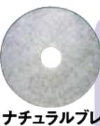
ナチュラルブレンド<br>ホワイトパッド | ●超高速バフイング作業用              | ①バフイングの前に床の汚れを取り除くため、3M™ ダスタークロスか水モップ、必要ならば自動洗浄機などで前処理をしてください。<br>②超高速ポリッシャーに装着し、回転のムラがないことを確認した後、作業を開始します。<br>③作業後、ワックスのかすなどを取り除くために、3M™ ダスタークロスがけを行います。 | 1500～<br>3000回転 |
