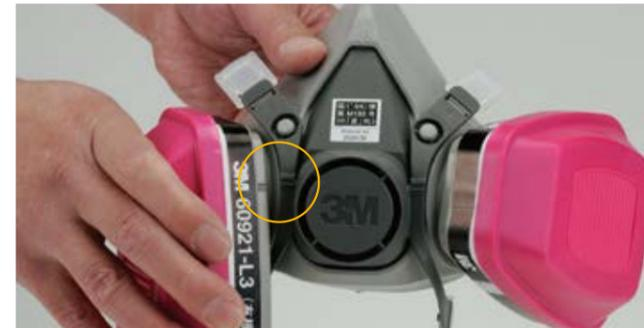
吸収缶は左右ともに時計方向に回して装着します。正面から見て右側の吸収缶は、上から下に回すように、左側の吸収缶は下から上に向かって回してください。
