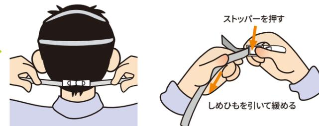
首の後ろでバックルを掛け、バックル外側のしめひもを引っ張ることにより、長さを調整します。この時、しめ過ぎに注意してください。しめひもを緩める時は、バックルストッパー部分を押しながらしめひもを引っ張ります。
