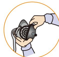
S1ろ過材を使用している場合には、別タイプのゴム製フィットチェックツール(別提供)を使用します。リテイナーの中心にある穴に差し込むようにして装着します。(検査方法は同様です)
