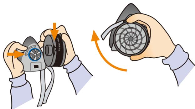
3M™ 吸収缶の矢印と面体の矢印の位置を合わせます。3M™ 吸収缶を面体に軽く押し付けるようにしながら時計方向に1/4回転させます。3M™ 吸収缶の矢印が面体「3M」マーク下部の矢印まできたら装着完了です。
