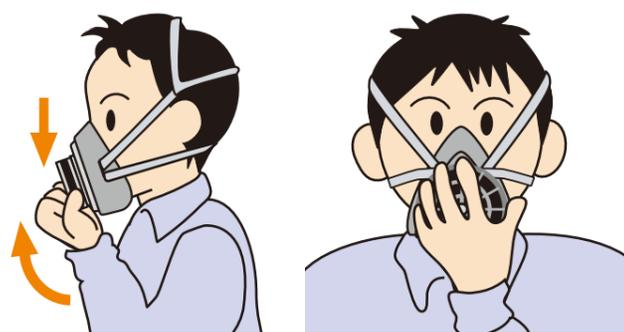
最後にマスクと顔の密着の良い場所に合わせるようにもう一度位置を調整してください。これで装着完了です。
