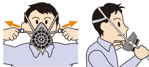
しめひもを左右に引いていくと、マスクが滑るように顔に近づいてきます。アゴと鼻が覆われるように注意しながらマスクを当てます。アゴを突き出し、マスクに乗せるように行ってください。
