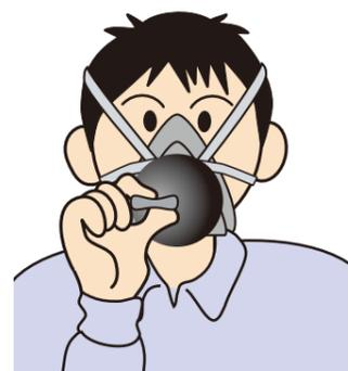
ゴム製のフィットチェックツール(別提供)を3M™ 吸収缶全体を覆うようにして被せ、装着します。
