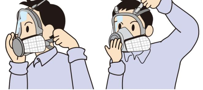
片手で面体を抑えたまま、下のしめひもを後ろに引くようにして、調整します。次に上のしめひもを調整します。面体がつぶれるなどの変形を起こすほど強く締め過ぎないように注意してください。
