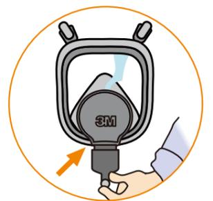
フィットチェック・ツールがない場合は、片手で排気弁の前を塞ぐことで、密着性の検査が行えます。
