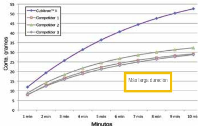
Como los datos de prueba mencionados revelan, la tecnología Cubitron™ II de 3M™ provee un promedio de corte significativamente más rápido y una mayor duración de funcionamiento que los abrasivos de primera calidad de la competencia que usan grano convencional.
