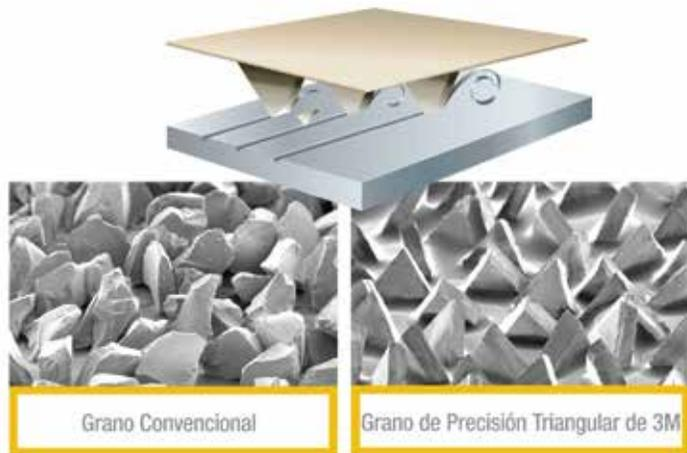
El Grano de forma triangular (imagen a la derecha) es electrostáticamente orientado para formar picos filosos, cada uno actúa como herramientas de corte individual que corta a través de la pintura y el relleno para carrocería, se desgasta uniformemente y proporciona larga duración y consistencia.
