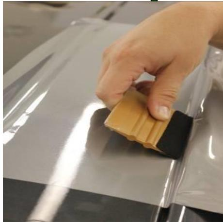
È molto importante **NON** spatolare la pellicola direttamente dopo il riscaldamento. Lasciare raffreddare la pellicola per alcuni secondi dopo il riscaldamento, quindi spatolare saldamente senza allungare il film. Lo stiramento ai bordi potrebbe causare il restringimento del film e lo sbiadimento del colore.
