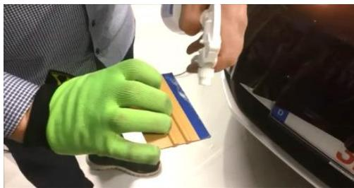
Applicare il film longitudinalmente dal centro verso l'esterno con tratti sovrapposti e assicurarsi che la spatola sia costantemente in contatto con il film. La tecnologia 3M™ Controltac assicura che il film sia flessibile sulla superficie e aderisca solo quando viene applicata pressione alla spatola, mentre la tecnologia 3M™ Comply consente di rimuovere facilmente l'aria senza provocare bolle.
