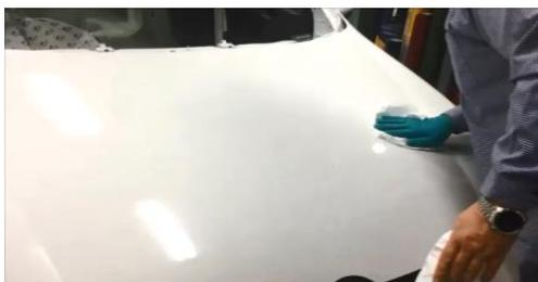
Dopo la pulizia, assicurarsi che la superficie e i bordi siano completamente asciutti. Il film aderisce male anche se la superficie è adeguatamente pulita ma con residui di acqua sui bordi ecc.
