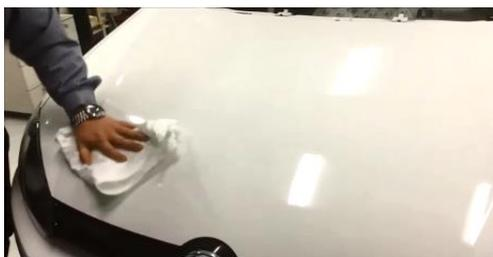
Nota: non utilizzare alcol isopropilico poiché ciò può influire sull'adesione del film. Altri solventi rispetto al 3M™ Surface Preparation System possono influenzare anche le proprietà di adesione del film.
