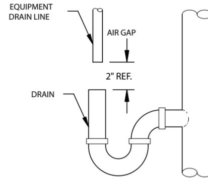
**Figure 3. TYPICAL DRAIN**
