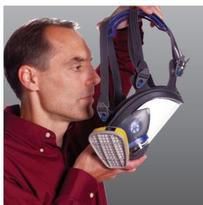
Afloje las seis bandas para la cabeza. Sostenga la parte delantera de la pieza facial con una mano y, con la otra, mantenga las correas o el apoyo elástico alejados de la pieza facial para crear la apertura necesaria para la cabeza. Coloque el conjunto del respirador sobre la cabeza y tire hacia abajo. Coloque la nariz en la copa nasal y el mentón en el área de apoyo para el mentón y luego presione firme y uniformemente la pieza facial contra el rostro.
