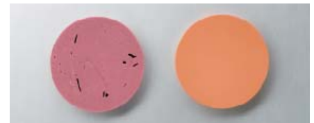
Un mélange homogène et sans bulle avec Express 2 Penta Putty Soft et Pentamix 3 (à droite) comparé au résultat obtenu avec un putty conventionnel en mélange manuel (gauche)
