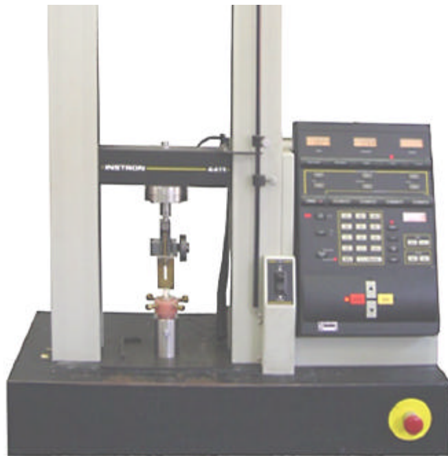
Figura 11 – Máquina de ensaio universal Instron (modelo 4411), com o corpo-de-prova posicionado para o ensaio de resistência ao cisalhamento.
