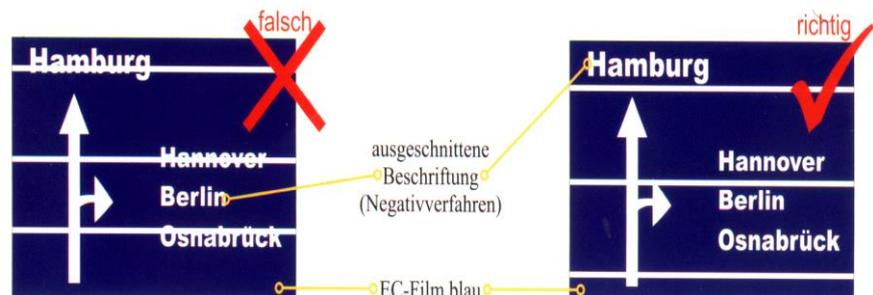
3. Um Blitzer zu vermeiden, sollte der EC-Film bei breiten Bahnen überlappend geklebt werden. Die Überlappung kann im Bereich von 1 - 3 mm ausgelegt werden. Dies muss im Plotter-Programm berücksichtigt werden. Im Bereich der Überlappung des EC-Films entsteht eine schmale dunkle Linie, die jedoch auf dem installierten Verkehrszeichen vom Verkehrsteilnehmer nicht wahrzunehmen ist.
