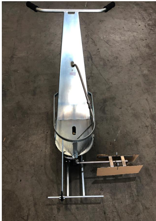
Anschrauben des Sprüharms
