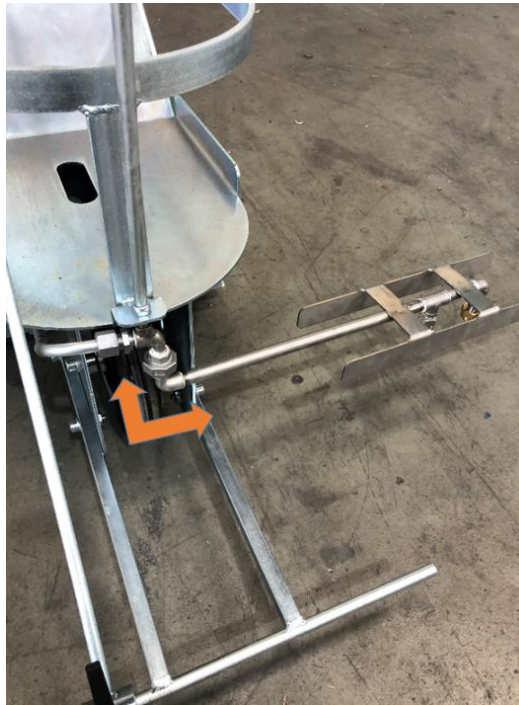
Anschrauben des Sprüharms
