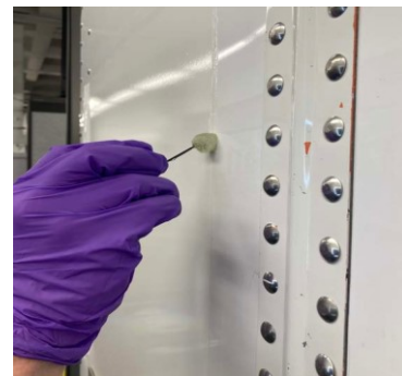
Figura 6. Applicazione del sigillante per bordi
