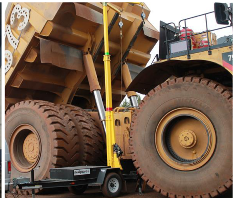
ระบบติดตั้งบนรถพ่วง (Trailer Mount System)
