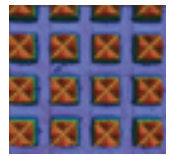
468LA: la última tecnología de microrreplicación que requiere menos presión por unidad, lo que mejora la vida útil del disco y la productividad
