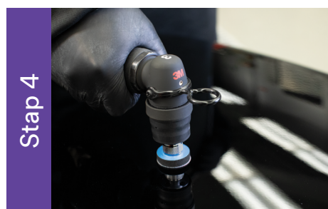
Schuur het defect 1 tot 3 seconden op, afhankelijk van de grootte.
