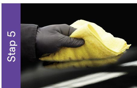
Veeg het gebied schoon met een microvezeldoek en inspecteer de reparatie.
