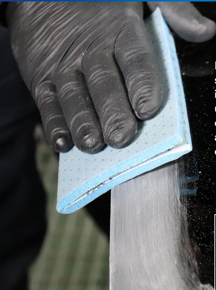
La construcción de espuma suave se adapta a superficies irregulares, lo que garantiza un acabado uniforme y consistente, en especial alrededor de los bordes y las esquinas de los paneles.
