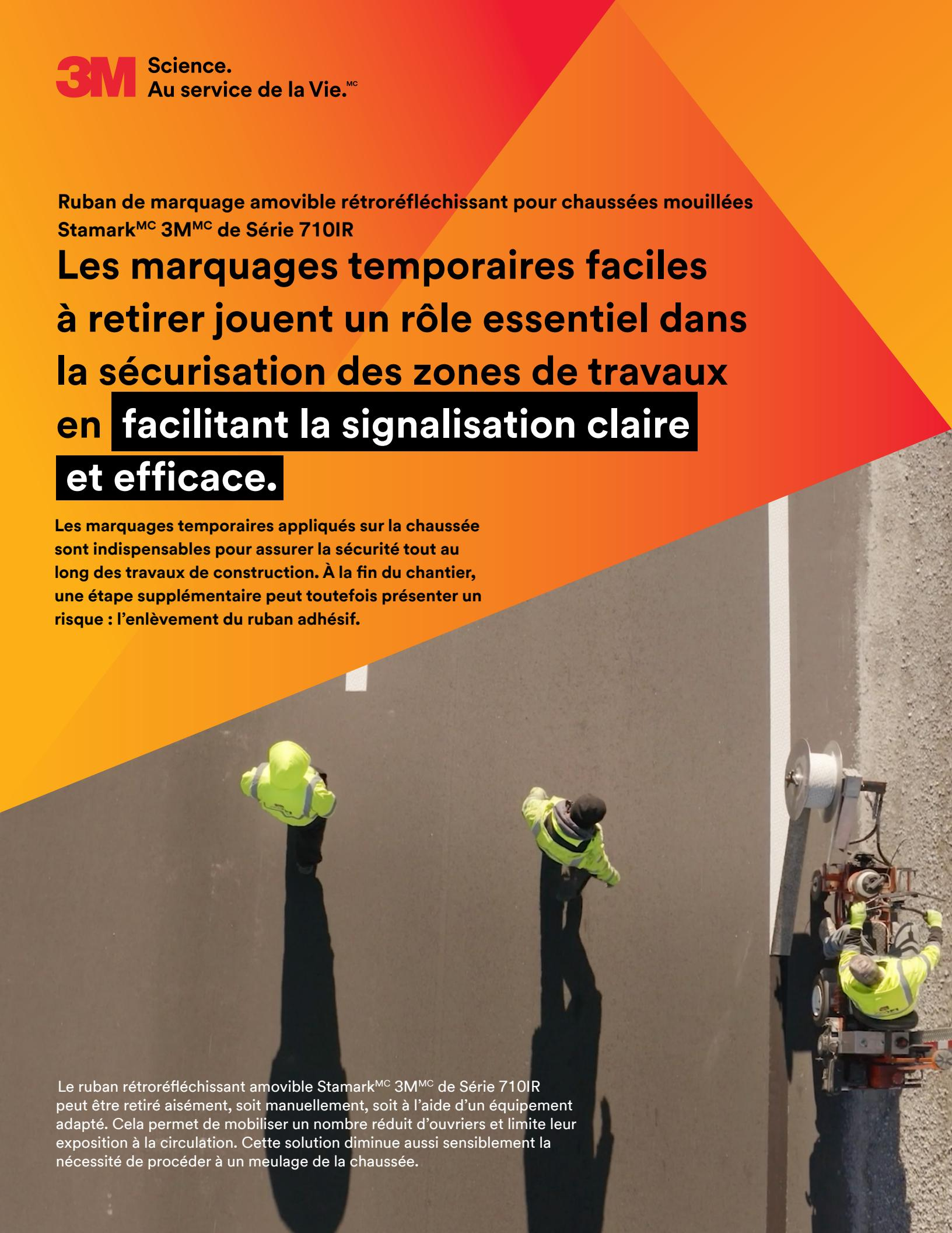
Le ruban rétroréfléchissant amovible Stamark<sup>MC</sup> 3M<sup>MC</sup> de Série 710IR peut être retiré aisément, soit manuellement, soit à l'aide d'un équipement adapté. Cela permet de mobiliser un nombre réduit d'ouvriers et limite leur exposition à la circulation. Cette solution diminue aussi sensiblement la nécessité de procéder à un meulage de la chaussée.
