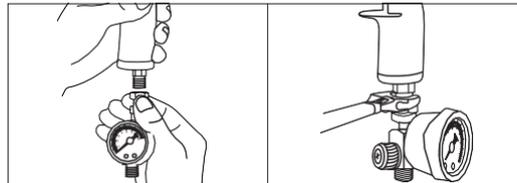
2. Fixez le tuyau flexible à pression à la base du pistolet de pulvérisation.
