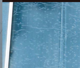
金属膜の劣化
