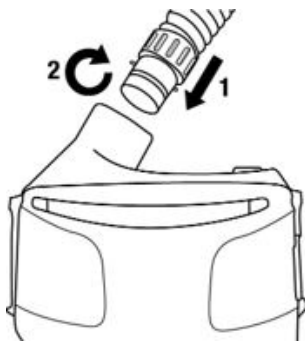
Fig. 10: Instalación del tubo de respiración
