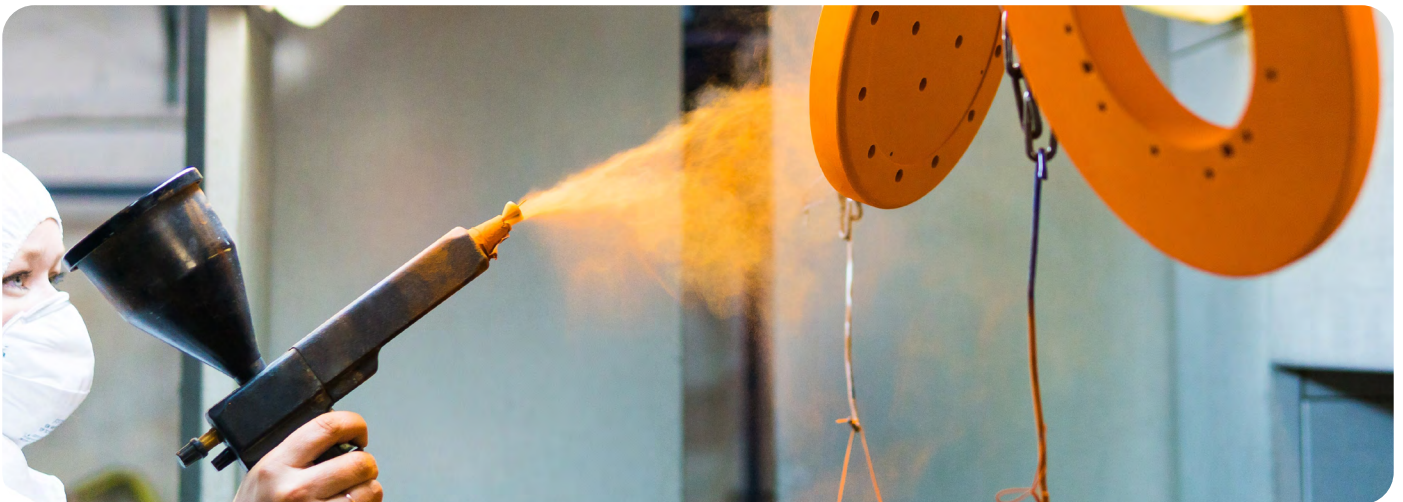
3M™ Polyesterklebeband 8992 wird verwendet, um Bereiche während des Pulverbeschichtungsprozesses vor der Farbe zu schützen.
