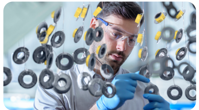
여기에 노란색으로 표시된 3M™ 비닐 테이프 471은 케미컬 배스에 넣기 전에 부품 영역을 마스킹하는 데 사용할 수 있으며, 공정이 완료되면 깔끔하게 제거할 수 있습니다.
