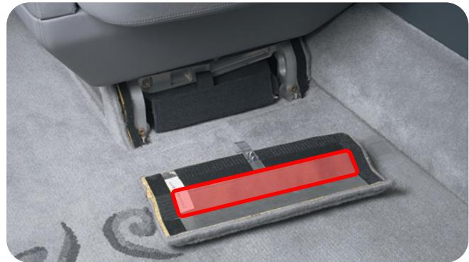
3M™ UHMW 필름 테이프 5423을 사용하여 두 개의 금속 부품을 분리한 자동차 시트 어셈블리는 표면 마모와 표면 마찰로 인한 소음을 제거할 수 있습니다.
