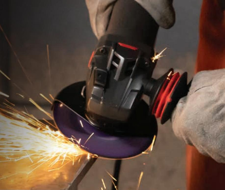
Disques à taux de coupe élevé et à longue durée de vie qui nécessitent moins de pression pour le meulage intensif et l'enlèvement des soudures.
