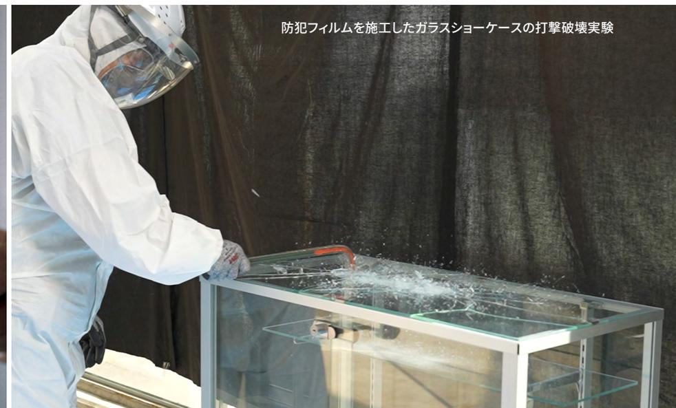
防犯フィルムを施工したガラスショーケースの打撃破壊実験
