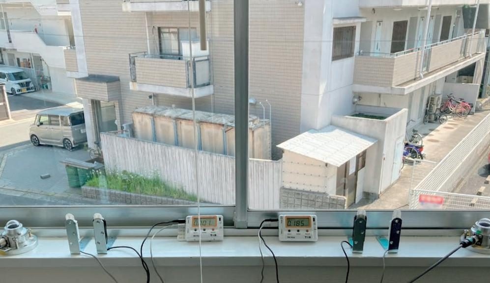
◀ 日射量、温度、紫外線量の測定の様子。左側の窓にはNANO80Sが貼られている。右側の窓は何も貼られていない。見た目には左右の透明度の差は分からない。
