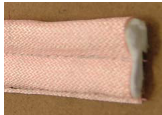
Selos em formato de cone de rabicho feitos com tecido Nextel (BF-20)*
