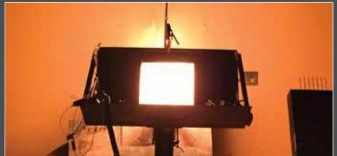
De acordo com as regulações de proteção contra incêndio da FAA, as carenagens de motores comerciais devem ser capazes de resistir a uma chama de 2.000°F (1.093°C) por 15 minutos sem penetração de chama. Os têxteis cerâmicos Nextel™ ajudam os fabricantes a superar essa exigência.
