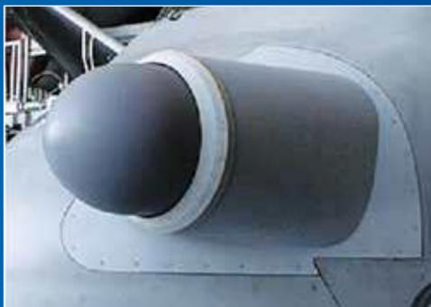
Devido à sua transparência eletromagnética, os PMCs feitos com fibras cerâmicas Nextel™ são ideais para aplicações tais como em radomes de aeronaves.
