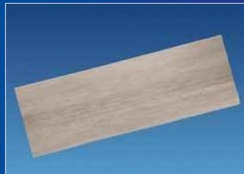
Compósitos à base de polímeros reforçados com fibras cerâmicas Nextel™ são projetados para aplicações que exigem resistência e rigidez combinada com não condutividade elétrica e transparência eletromagnética, tal como em componentes estruturais de aeronaves, pás de rotor e radomes.
