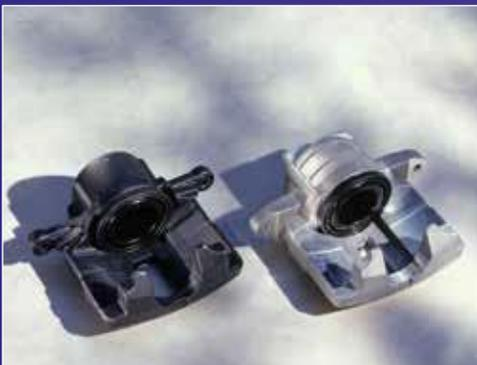
As pinças de freio de compósitos de matriz metálica utilizando tecidos cerâmicos Nextel™ pesam metade do aço ou ferro fundido, mas possuem resistência e rigidez iguais ou superiores.
