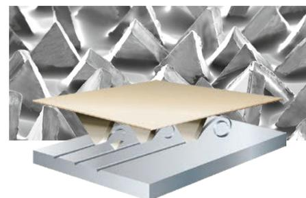
Les abrasifs 3M™ Cubitron™ II sont conçus avec la technologie révolutionnaire de grains profilés calibrés 3M. Ce grain de forme triangulaire s'aigise en continu avec l'usure. Il forme ainsi des pointes et des angles aigus qui tranchent le matériel, s'usent de façon uniforme et offrent une durée de vie supérieure et un résultat plus homogène.
