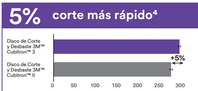
4. Los resultados se basan en un biselado automatizado de barras de acero al carbono 1018 con un disco abrasivo de 115 mm de diámetro exterior montado en un motor de control preciso (servomotor), aplicando una fuerza de 12 libras. La velocidad de corte fue definida por el metal eliminado después de 10 minutos de prueba. Se considera que el final de la vida útil es el 50 % de la masa inicial de la rueda.
