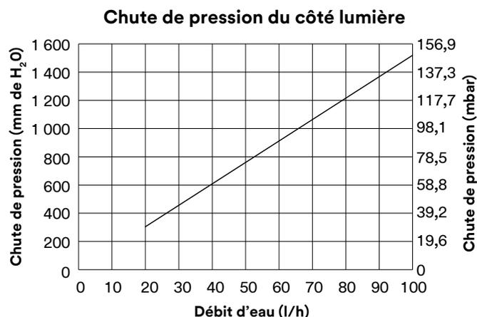
Les courbes de chute de pression représentent les valeurs nominales utilisant de l'eau. Les caractéristiques peuvent changer selon les conditions de fonctionnement. Ces graphiques ne doivent pas être utilisés pour concevoir des systèmes.
