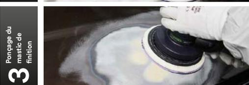
3 Ponçage du mastic de finition
