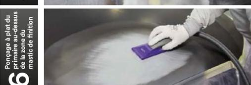
6 Ponçage à plat du primaire au-dessus de la zone du mastic de finition
