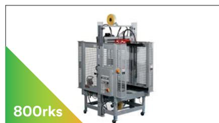
**O Fechador de Caixas 3M-Matic™ 800rks:** é um fechador de caixas de tamanho grande aleatório que se ajusta automaticamente à altura e à largura da caixa e é capaz de fechar até 10 caixas por minuto, usando larguras de fita de 48 mm a 72 mm.
