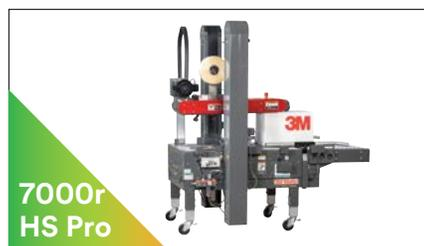
**O Fechador de Caixas 3M-Matic™ 7000r Pro aleatório de alta velocidade:** projetado para se ajustar automaticamente a uma variedade de tamanhos de caixas. Pode fechar até 28 tamanhos diferentes de caixas por minuto.
