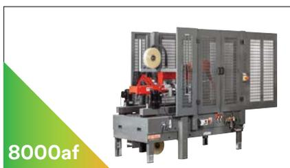
**O Fechador de Caixas 3M-Matic™ 8000af** é uma máquina para dobradura de abas automática, que fecha a parte superior e inferior de uma caixa sem operador.
