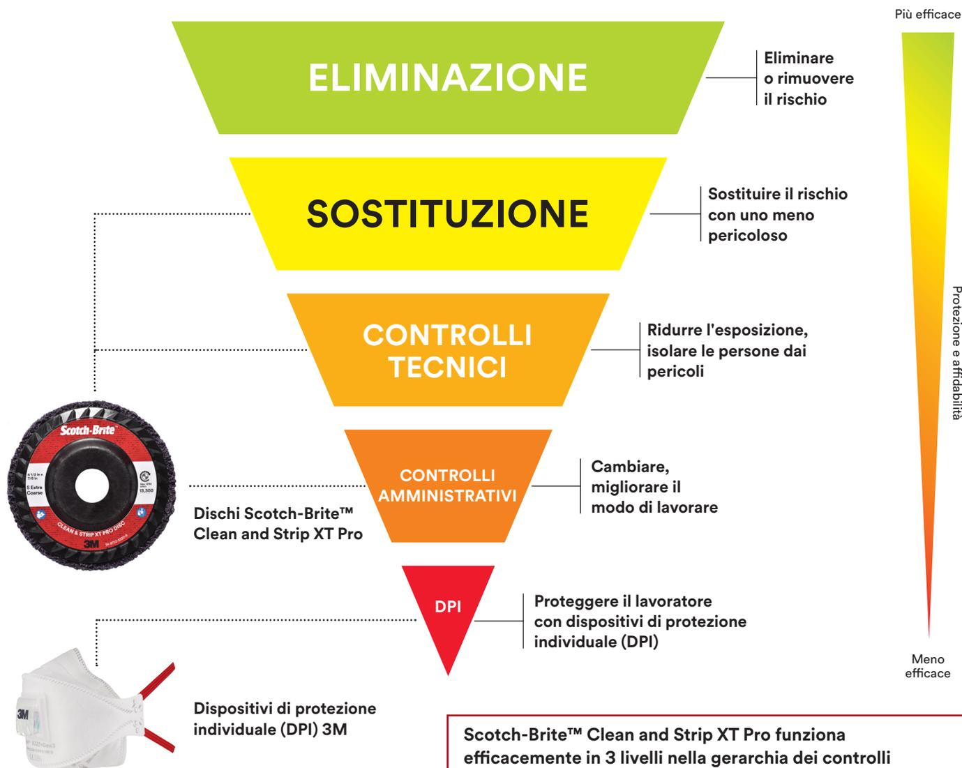
Scotch-Brite™ Clean and Strip XT Pro funziona efficacemente in 3 livelli nella gerarchia dei controlli a seconda del rischio originale. Ad esempio, è possibile dimostrare che la sostituzione di un'applicazione con spazzola a filo metallico con XT Pro riduce il rischio di tagli e rimuove il rischio di fili volanti
