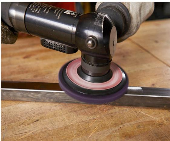
**Il disco Scotch-Brite™ Clean and Strip XT Pro è progettato per la rimozione della calamina e per ridurre al minimo le vibrazioni:**
