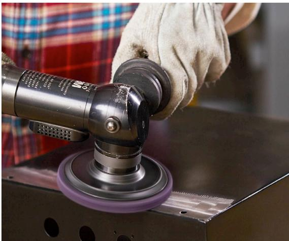
**Il disco Scotch-Brite™ Clean and Strip XT Pro è progettato per la rimozione della vernice e per ridurre al minimo le vibrazioni:**
