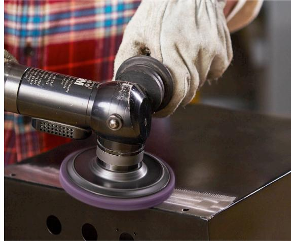
Scotch-Brite™ Disco Clean and Strip XT Pro está diseñado para eliminar pintura y minimizar la vibración:
