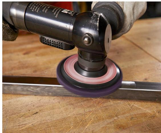
Scotch-Brite™ Disco Clean and Strip XT Pro está diseñado para eliminar calamina y minimizar la vibración:
