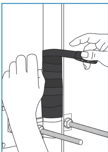
**9** Aplique a Fita de Vinil Scotch® Super 33+ a uma polegada além da Fita de Massa 3M™ 2212. Aplique três camadas da Fita Scotch® Super 33+.
