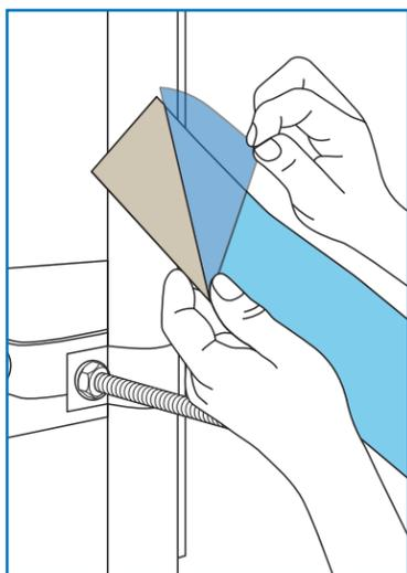
**1** Exponha a superfície adesiva removendo o suporte para o Absorvedor PIM externo 1000 da 3M™.
