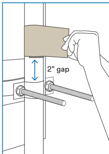
**2** Fixe uma extremidade da fita do absorvedor ao poste e enrole-a em volta da superfície.
