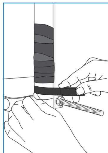
**7** Aplique a Fita de Vinil Scotch® Super 33+ a uma polegada além da Fita de Massa 3M™ 2212. Aplique três camadas da Fita Scotch® Super 33+.
