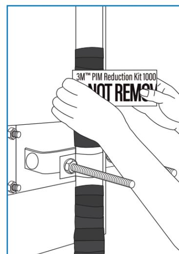
**11** Aplique a etiqueta "Não remover" ao redor das fitas previamente instaladas e coloque etiquetas adicionais, se desejar.
