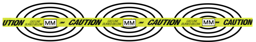
Figure 6 : Vue de dessus du diagramme directionnel de détection des marqueurs de chemins
