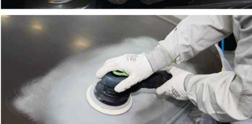
► Lijado orbital con abrasivos 3M 400+ - P500.
