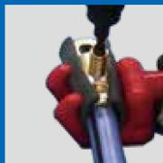
コネクタを導体に挿入し、ねじを締めこむことにより取り付けます。また、指定のトルクに達するとネジがねじ切れる構造となっているため特別なトルク管理も不要です。
