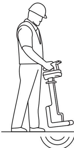
**Hinweis:** Die Tiefen sind Näherungswerte. Ziehen Sie das Datenblatt des Markers und die Kompatibilität des Ortungsgeräts zu Rate, um die maximale Tiefe jedes Markermodells zu bestimmen.
